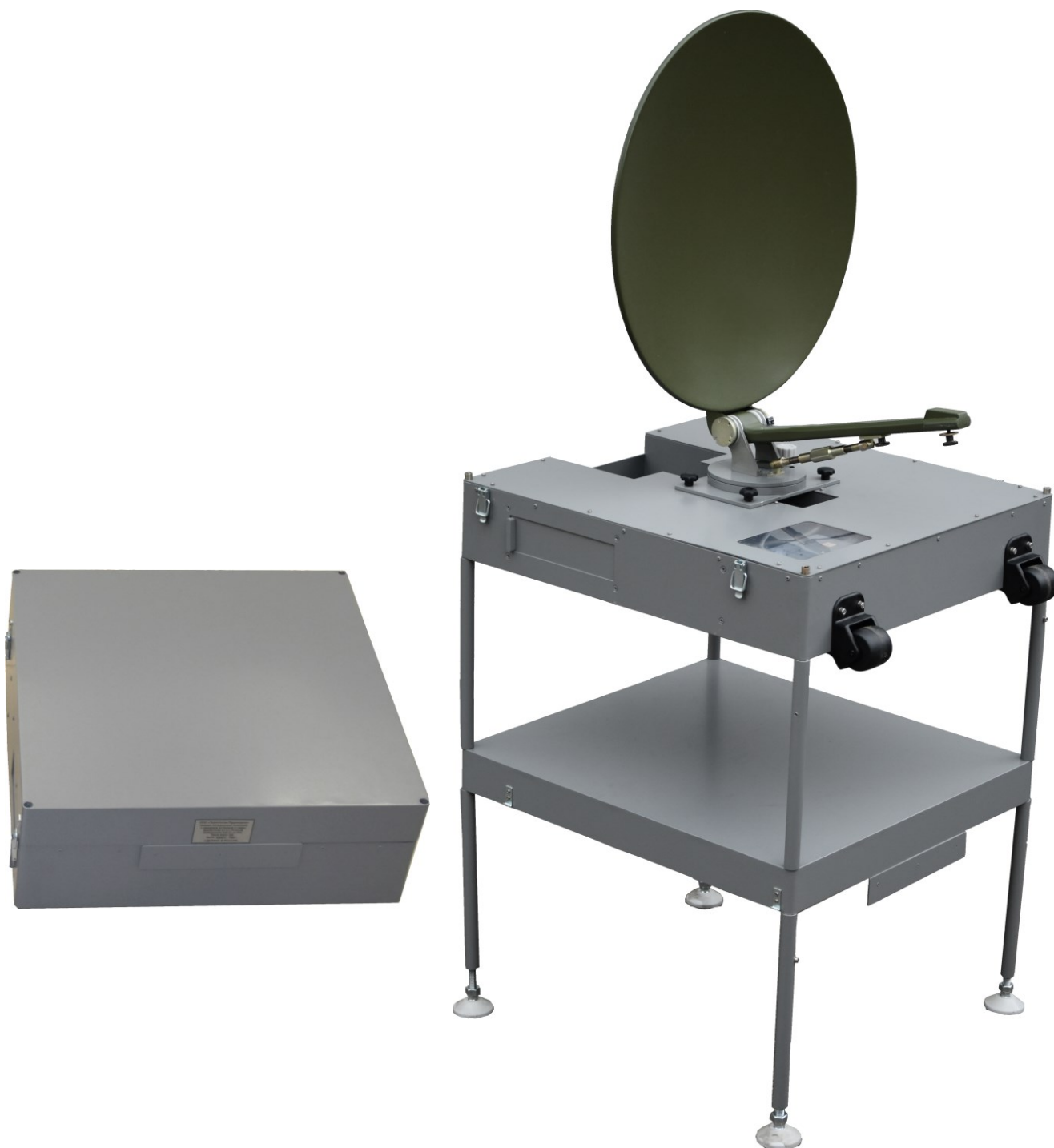
Рисунок 5- Внешний вид антенны в сложенном и развернутом положении
